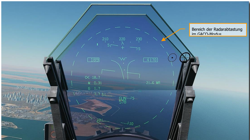
Abbildung 165. Luft-Luft-Kanone, Bereich der automatischen Aufschaltung165
