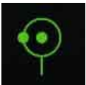
PPLI-Symbol einer luftbeweglichen Befehlsstelle (AWACS). Positionsangabe mit Zugriff auf einen Aufklärersensor (SURV).
